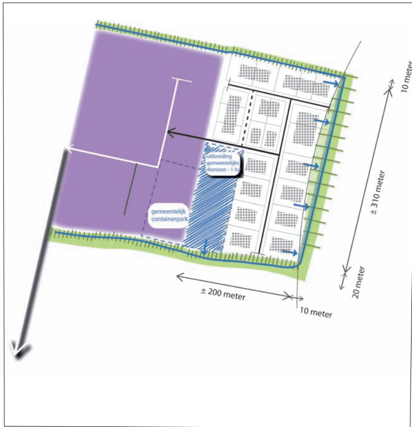
concept inrichting : voorbeeld 2 : 4,5 ha netto i.f.v. lokaal bedrijventerrein + ± 1 ha i.f.v. gemeentelijke diensten
