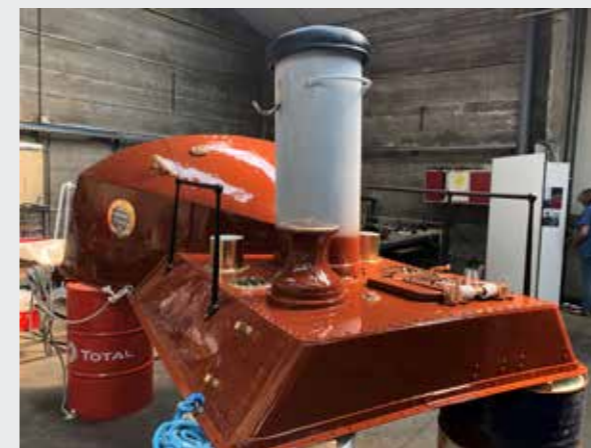
De kap waarmee de motor wordt afgeschermd werd gezandstraald en voorzien van een nieuwe laag verf.
